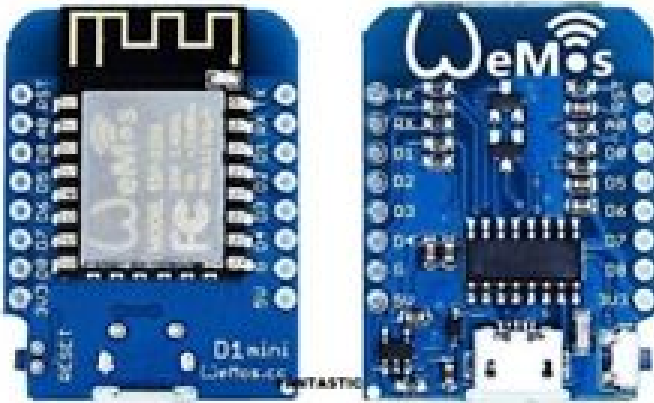
WeMos D1 Mini V2 ESP8266 ESP-12
