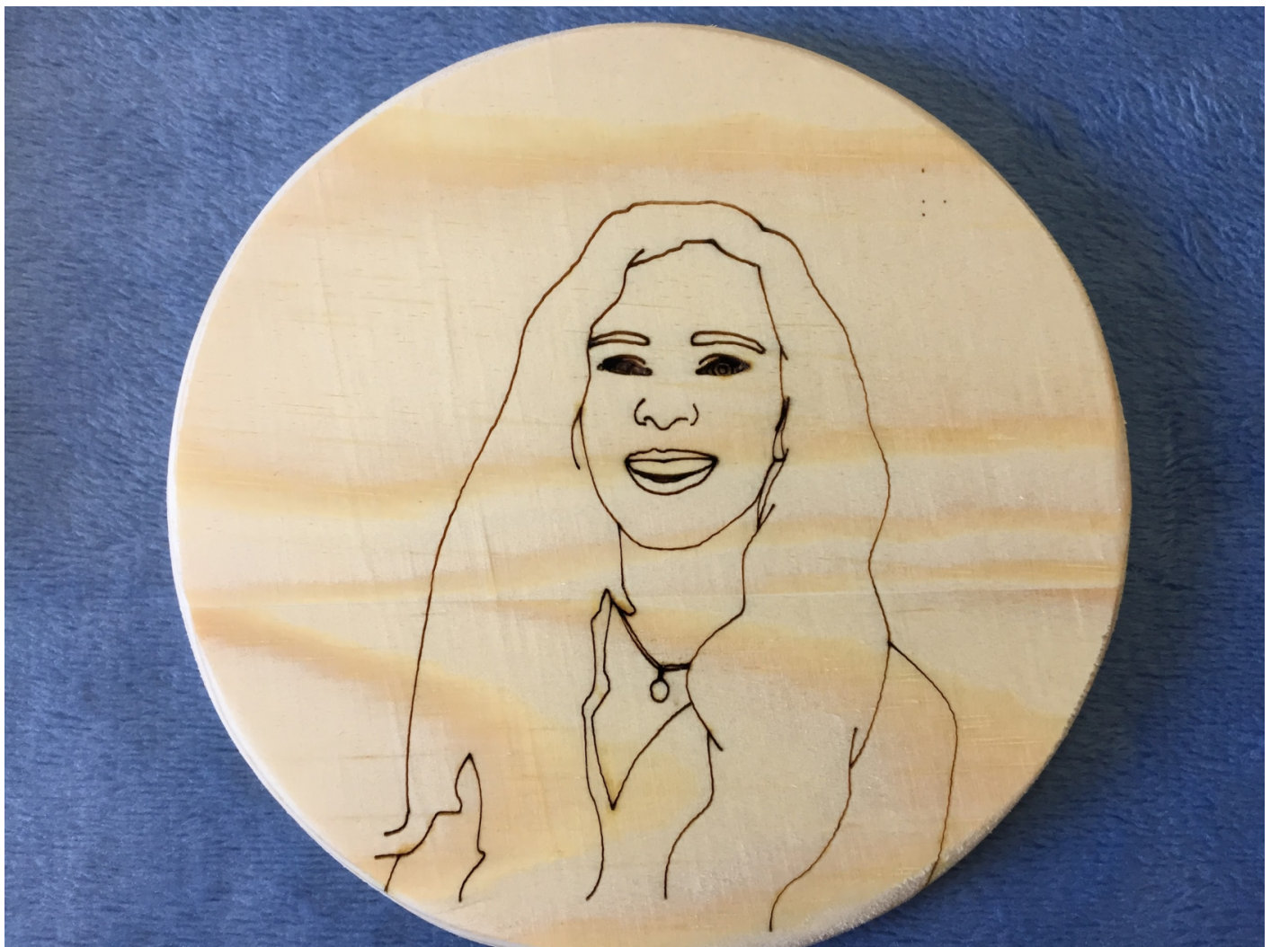
Dessin initial gravé à la découpe laser, ici sur du pin (paramètres 100-25)... en quelques minutes !
