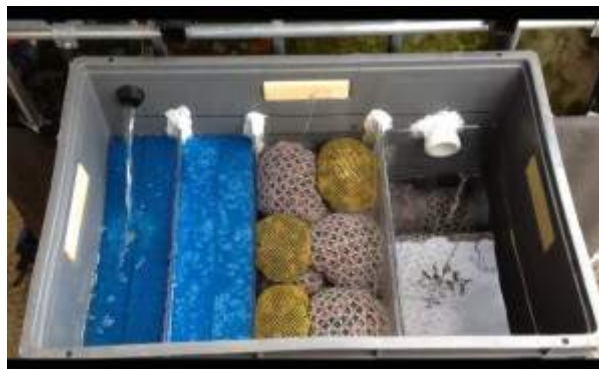
bio-filtre bricolé « maison » avec mousses, substrat et pouzzolane
